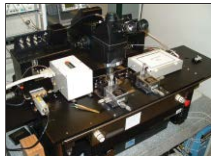
▲ Fig. 2 A 50 GHz Noise Parameter Measurement System.
